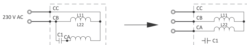
Typowy schemat silnika jednofazowego z kondensatorem rozruchowym
